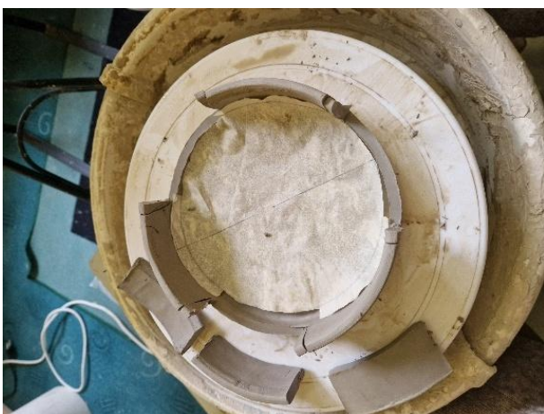
Joonis 5 Šabloon jalgade eemaldamiseks aluse valatud vormi küljest+ kahe vormi jalad
