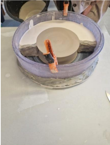
Joonis 10 Kolmeosalise kipsvormi teise seina valamine
