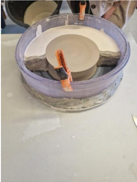
Joonis 11 Kolmeosalise kipsvormi teise seina valamine
