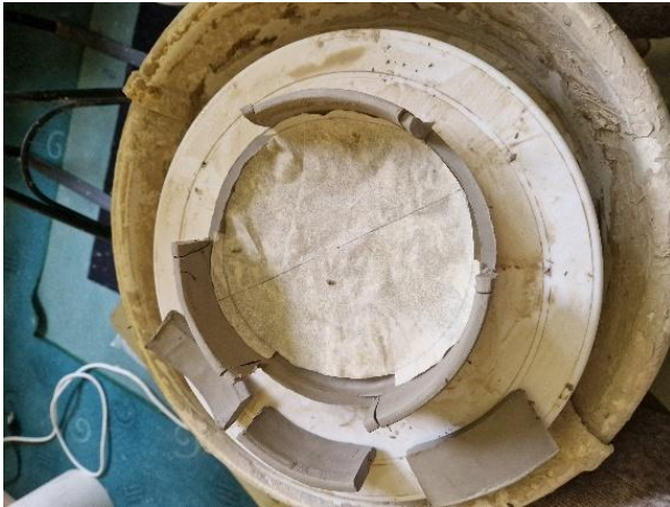
Joonis 6 Šabloon jalgade eemaldamiseks aluse valatud vormi küljest+ kahe vormi jalad
