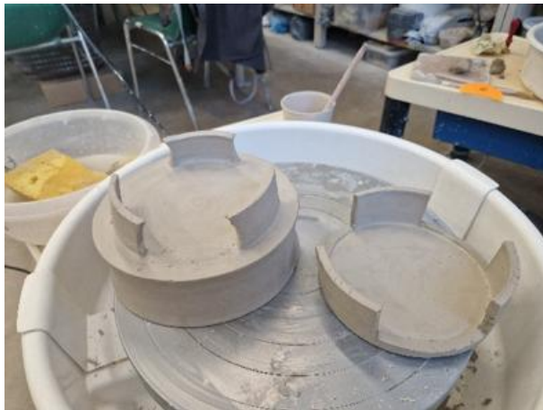
Joonis 5 Algse jalgade kõrgus, mis sai vähendatud 1,5 cm peale
